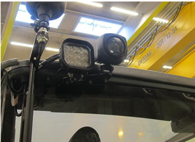
Bluespot sikkerhetslys, LED blå, monteret i mast for å lyse framover.
