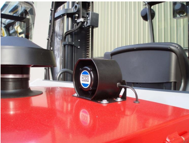
Ryggealarm - med automatisk lydstyrke 87-112 dB (A).
